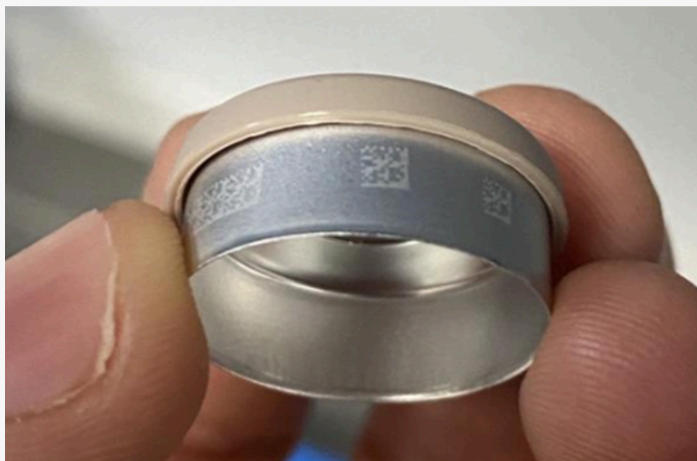
Figura 4: marcatura su siringhe monoso con corpo in vetro: 1,5 mm DM 14x14 Il codice Datamatrix viene marcato in meno di 50 ms utilizzando un laser a impulsi ultrabrevi NIR. La marcatura multiraggio riduce significativamente il rischio di microfessurazioni.
