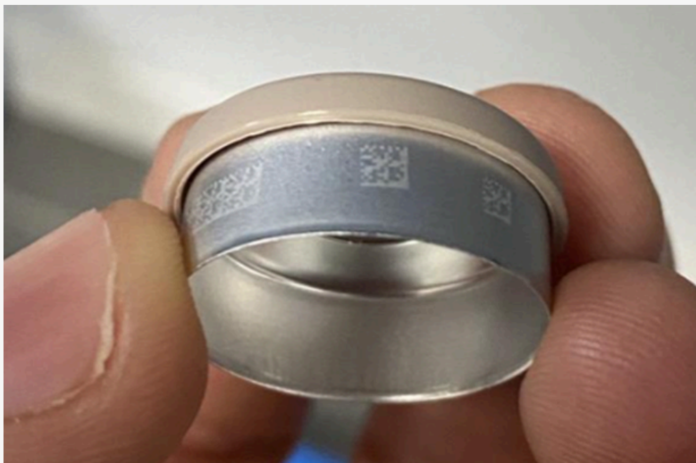
→ Figura 5: Marcado en tapones de aluminio anodizado para viales: se marca un código Datamatrix de 2 mm DM 12x12 en un solo pulso (tiempo de marcado <10 ns), utilizando un láser pulsado NIR.
