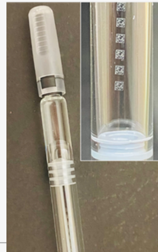
Figura 4: marcado en jeringas de un solo uso con cuerpo de vidrio: 1,5 mm DM 14x14 El código Datamatrix se marca en menos de 50 ms utilizando un láser de pulso ultracorto NIR. El marcado multihaz reduce significativamente el riesgo de microfisuras.
